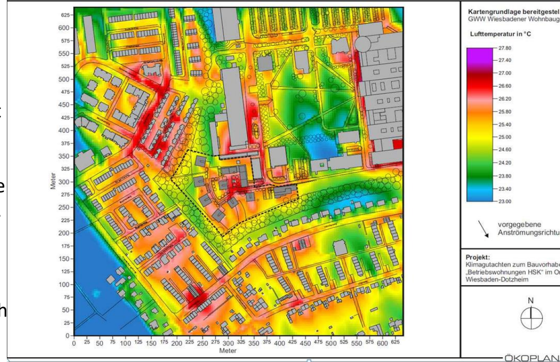
Abb. 30.2 Plan-Zustand, Ergebnisse mikroskaliger Lufttemperatursimulationen. Nachtsituation (23:00 Uhr). Lufttemperatur 2 m ü.G. bei einer Windanströmung aus Nordnordwesten (330°) mit 1.5 m/s in einer Höhe von 20 m ü.G.
